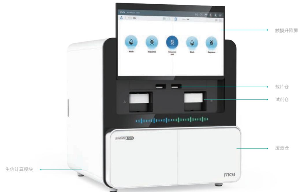
基于华大智造核心的DNBSEQ™测序技术，通过对生化、流体、光学、温控等核心系统的优化和提升，DNBSEQ-G99是目前全球中小通量测序仪中速度最快的机型之一，特别适用于小样本量的肿瘤靶向测序、小型全基因组测序、低深度WGS测序、个体识别等多种应用，例如24-48个样本的小Panel测序，或1-4个样本的WES测序。
